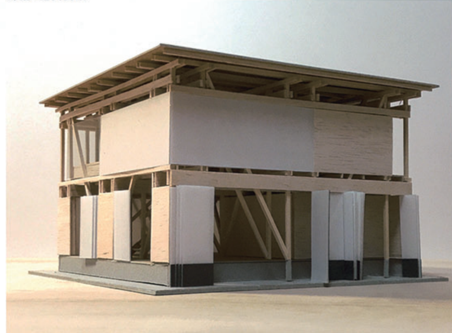
間引かれた大壁の隙間に建具をはめている
