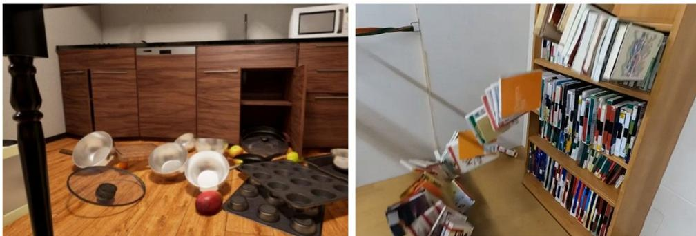
地震発生直後の居室の様子をCGで作成し、震度6強の揺れをVR映像で再現。家具の転倒防止策を実施している場合と、そうでない場合とを臨場感をもってご体験いただけるほか、実際に振動台を使用し過去の地震を再現(※1)した実写映像を用いて、家具の転倒防止策の効果と実施方法(※2)をご紹介します。
